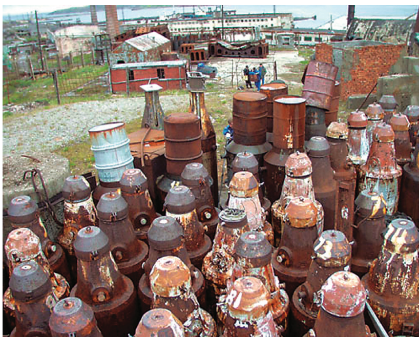
Рис. 2 Контейнеры с ОЯТ и ТРО на площадке хранения в п. Гремиха
