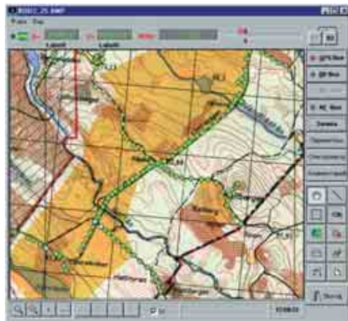
Отображение результатов измерения мощности дозы по маршруту движения
