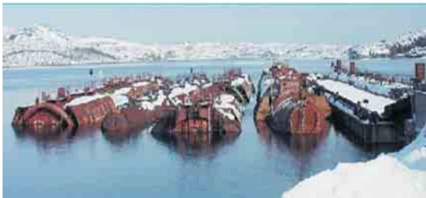
Причал в пункте временного хранения реакторных отсеков «Сайда»
