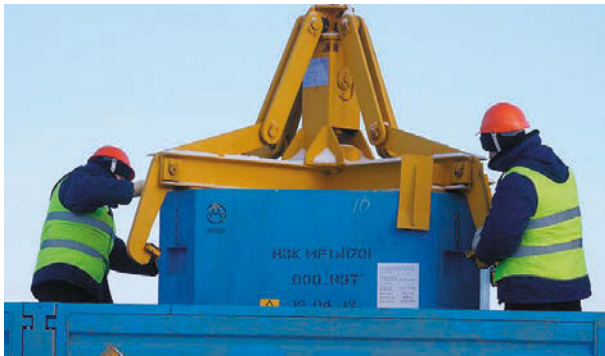
Рис. 1. Зацепление упаковки РАО с использованием полуавтоматического захвата [4]
