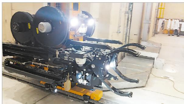
*Рис. 3. Разработанный по специальному заказу робот для извлечения отходов из пристанционного ПХ АЭС Каорсо (Италия)*
