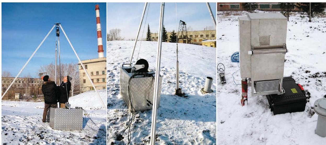
Рис. 9. Процесс сборки, настройки измерительного комплекса нейтрон-гамма каротажа (слева); проведение нейтрон-гамма каротажа через инспекционный канал на ПХ РАО ЭИ-2 (в центре); проведение нейтрон-нейтронного каротажа через инспекционный канал на ПХ РАО ЭИ-2 (справа)
