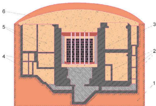
Рис. 2. Пункт хранения РАО ЭИ-2 АО «ОДЦ УГР»: 1 – вмещающие породы; 2 – стены шахты реактора и конструкции здания (бетон); 3 – графитовая кладка и основные металлоконструкции реактора; 4 – забетонированные пространства под реактором; 5 – барьерный материал на основе глины в полостях реакторного пространства и помещениях, окружающих шахту реактора; 6 – защитный экран
