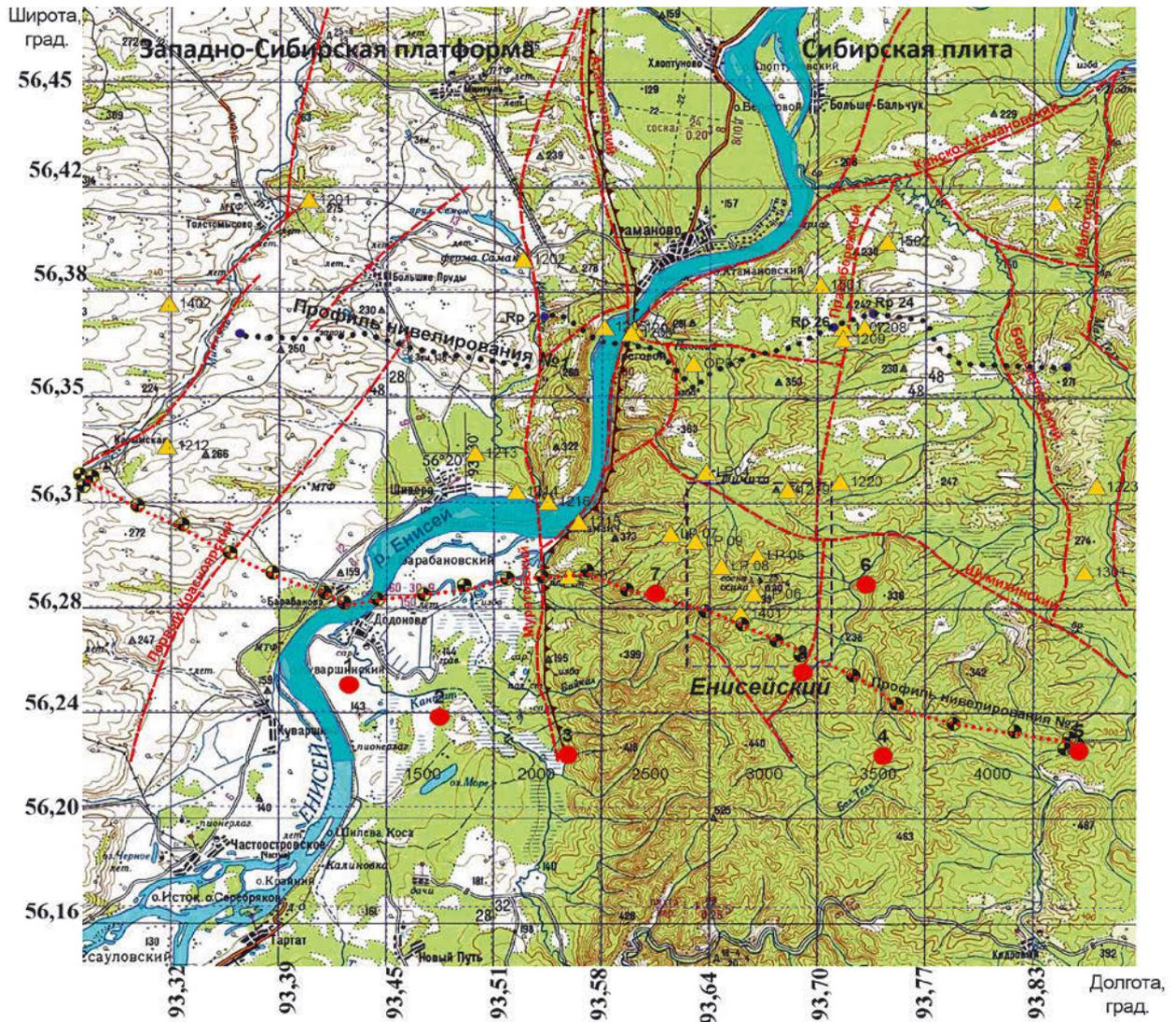
Рис. 2. Схема геодинимических наблюдений в 2019–2024 гг. Желтые треугольники – существующие ГНСС-пункты, красные кружки – новые ГНСС-пункты, черный пунктир – существующий профиль повторного нивелирования № 1, красный пунктир – новый профиль повторного нивелирования № 2
