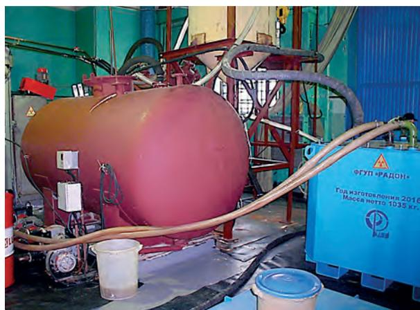
Рис. 4. Пропитка ИОС в контейнере КМЗ полимерным связующим
