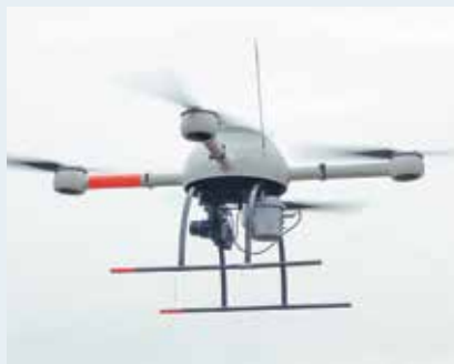
Беспилотный летательный аппарат (БПЛА) с анализатором аэрогаммасымки
