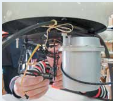
Специально разработанный легкий гамма-спектрометр УДКГ-А01 для подвески на БПЛА весом 0,6 кг
