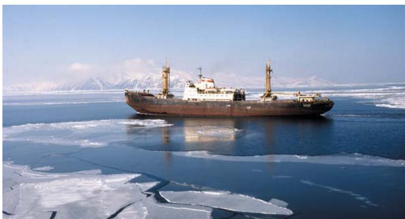
Рис. 2. Дизель-электроход грузовой ледового класса «Амгуэма»
