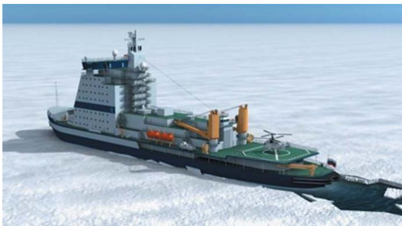
Рис. 9. Универсальный атомный ледокол мощностью 60 МВт
