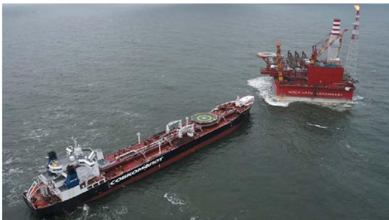
Рис. 8. Отгрузка нефти с платформы «Приразломная»
