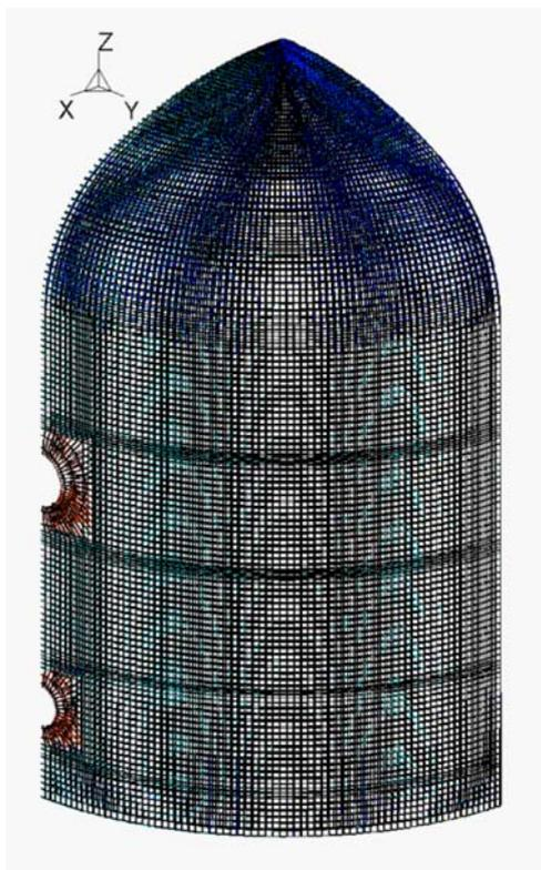
*Рис. 2.* Трехмерная система стержневой арматуры внутри стенки защитной оболочки
