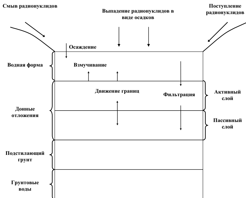
Рис. 6.2. Пути миграции радионуклидов в системе «поверхностный источник — донные отложения»
