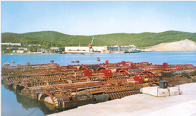
Хранение трехотсечных реакторных блоков на плаву в бухте Разбойник
