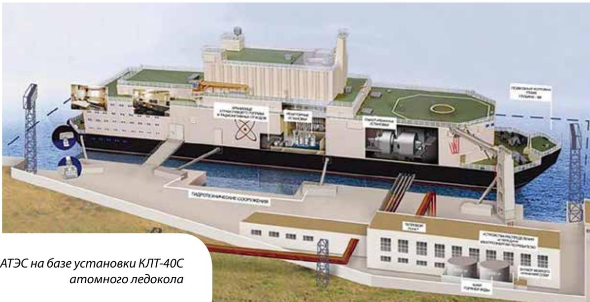
Плавающая АТЭС на базе установки КЛТ-40С атомного ледокола
