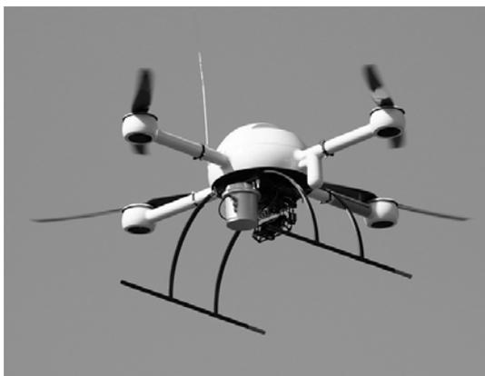
Рис. 1. Беспилотный летательный аппарат md4-1000 с полезной нагрузкой в виде измерительного блока
