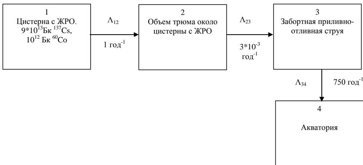
Рис. 7. Камерная модель для расчета активностей ПД в морской воде около затонувшего САТО с поврежденной цистерной с ЖРО.
