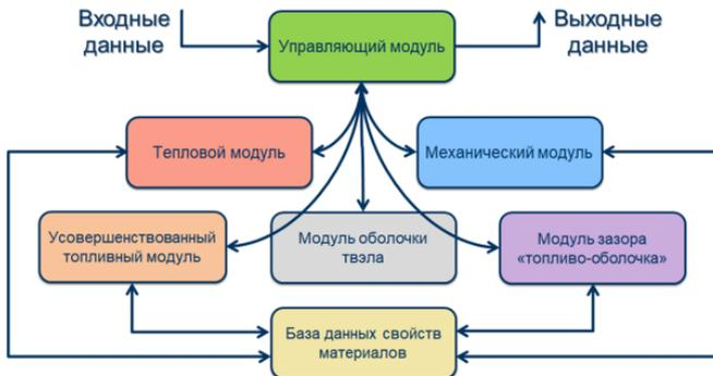
Рисунок 1 – Модульная архитектура кода БЕРКУТ-У
