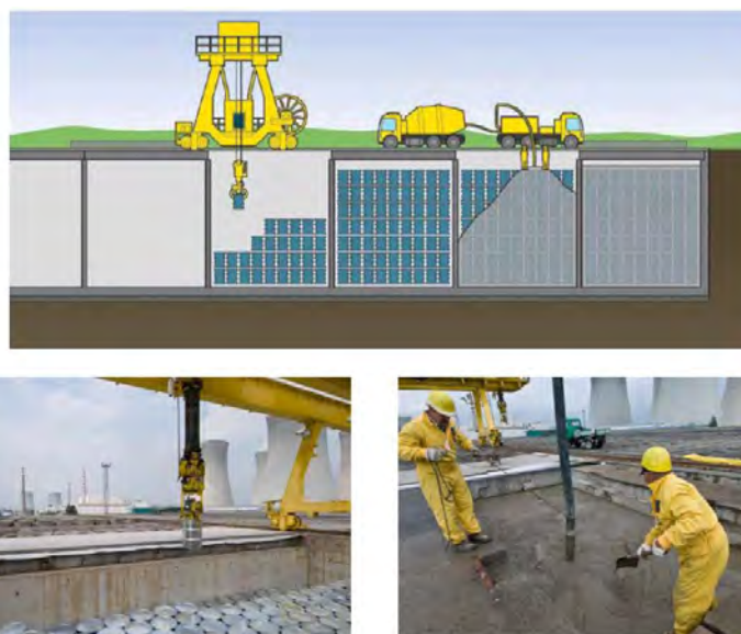
Рисунок 1.18 – ППЗРО для низко- и среднеактивных РАО в Чехии, на площадке АЭС Dukovany [111]
