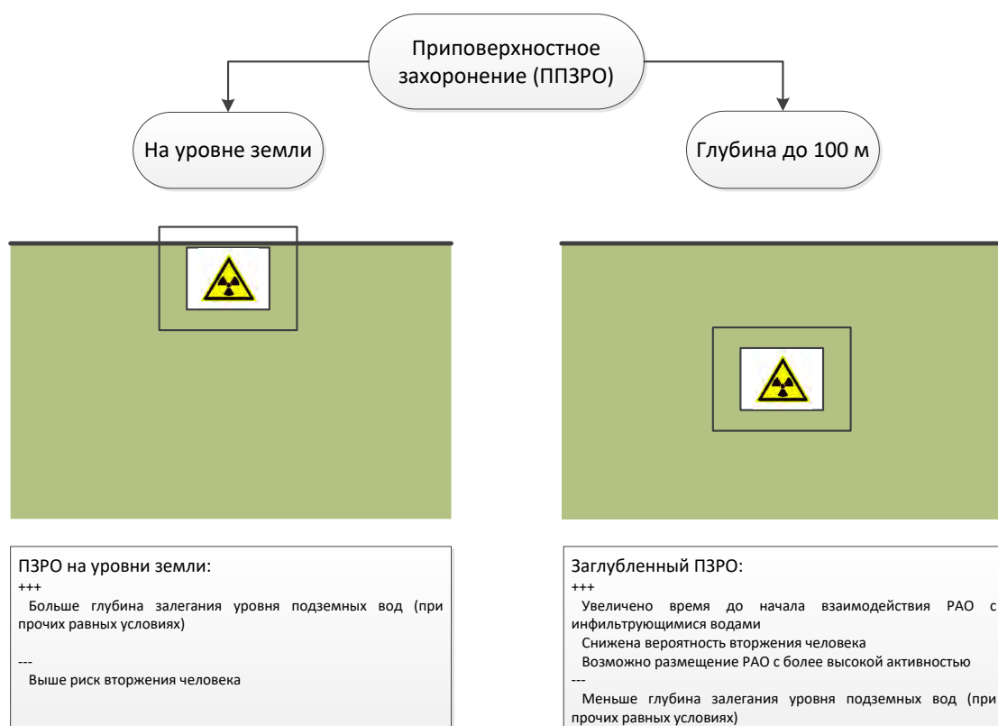
Рисунок 1.6 – Варианты сооружений захоронения приповерхностного ППЗРО различного заложения [70]
