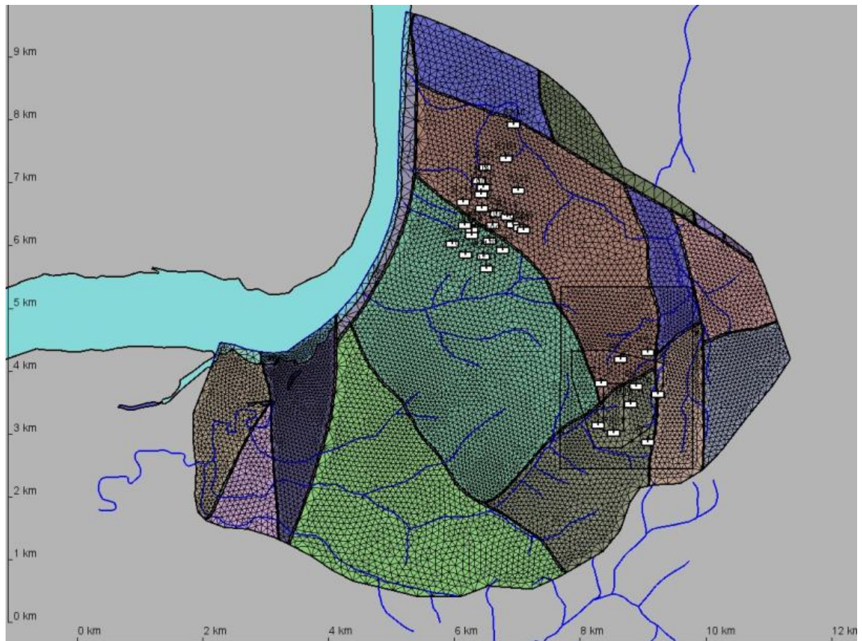
Рисунок 5.2.12 – Сетка расчетной области (вид в плане)
