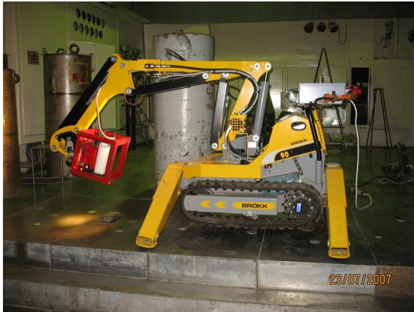
Рисунок 2.40 - Обследование приреакторного хранилища ОЯТ с помощью измерительного комплекса «Гамма-Пионер»
