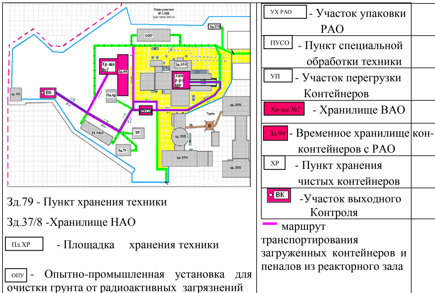
Рисунок 4.32 - Логистическая схема обращения с РАО на территории реакторного комплекса МР и РФТ
