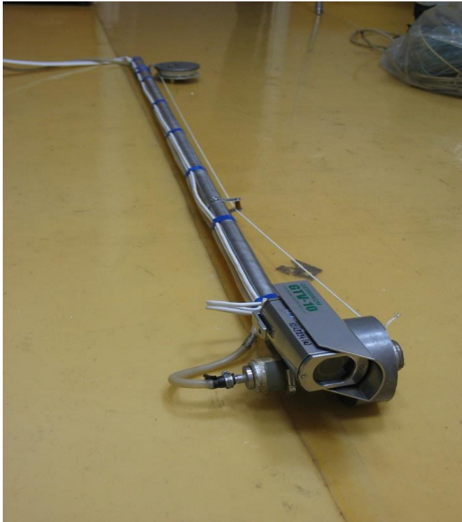
Рисунок 2.46 - Детектор для сканирования внутренних поверхностей камеры резки
