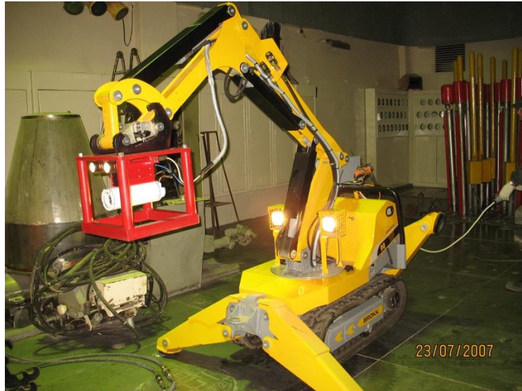
Рисунок 2.6 - Мобильный измерительный комплекс «Гамма-Пионер»
