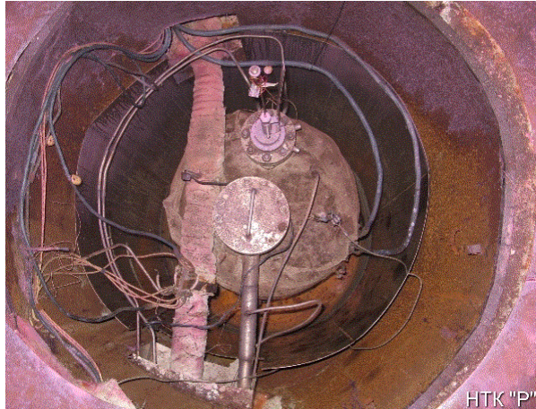
Рисунок 4.13 - Монжус петлевой установки ПВМ
