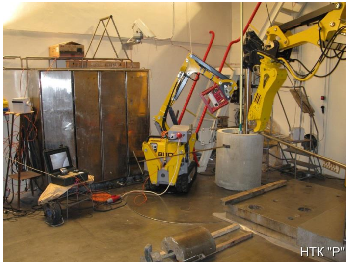
Рисунок 4.1 - Технология резки канала со сборкой, установленной над горловиной транспортного люка камеры резки
