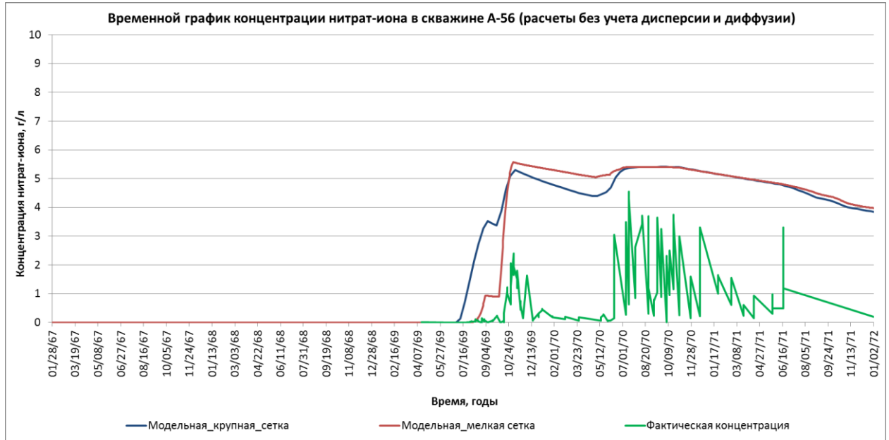
Рисунок 3.19 – Сравнение расчетных кривых концентрации нитрат-иона в скважине А-56 на разных сетках без учета процессов диффузии и дисперсии
