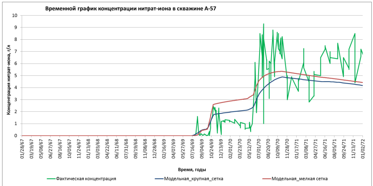
Рисунок 3.16 – Сравнение расчетных кривых концентрации нитрат-иона в скважине А-57 на разных сетках
