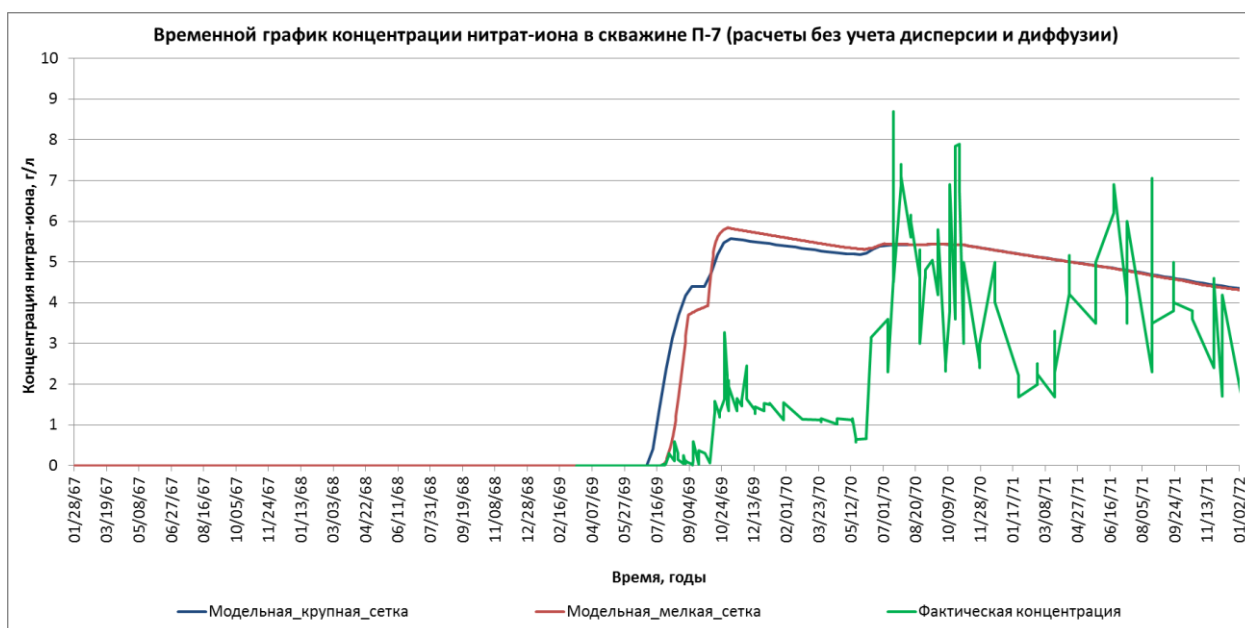
Рисунок 3.18 – Сравнение расчетных кривых концентрации нитрат-иона в скважине П-7 на разных сетках без учета процессов диффузии и дисперсии
