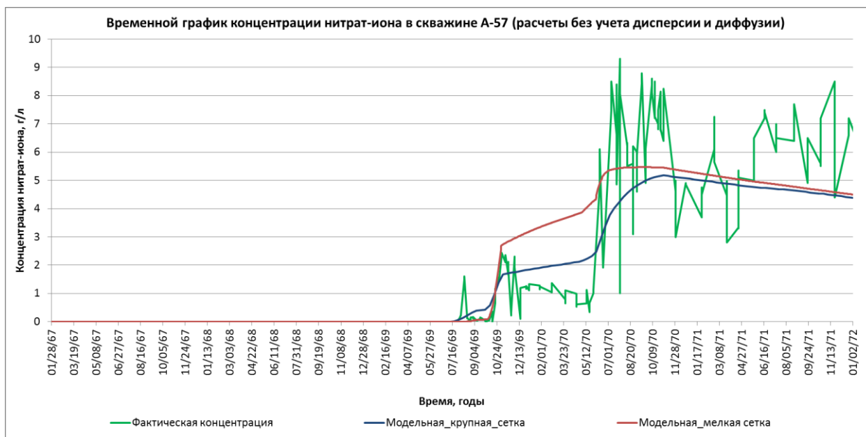
Рисунок 3.17 – Сравнение расчетных кривых концентрации нитрат-иона в скважине А-57 на разных сетках без учета процессов диффузии и дисперсии
