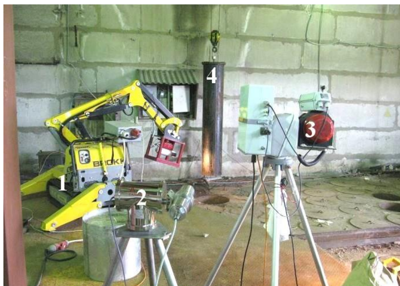
Рисунок 2 - Расположение измерительного оборудования при сканировании пеналов с высокоактивными отходами (1 – радиометрический комплекс «Гамма-Пионер»; 2 – «Гаммавизор»; 3 – «Гамма-локатор»; 4 – измеряемый пенал)
