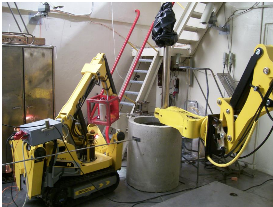
Рисунок 8 - Технология резки канала со сборкой, установленного над горловиной транспортного люка камеры резки
