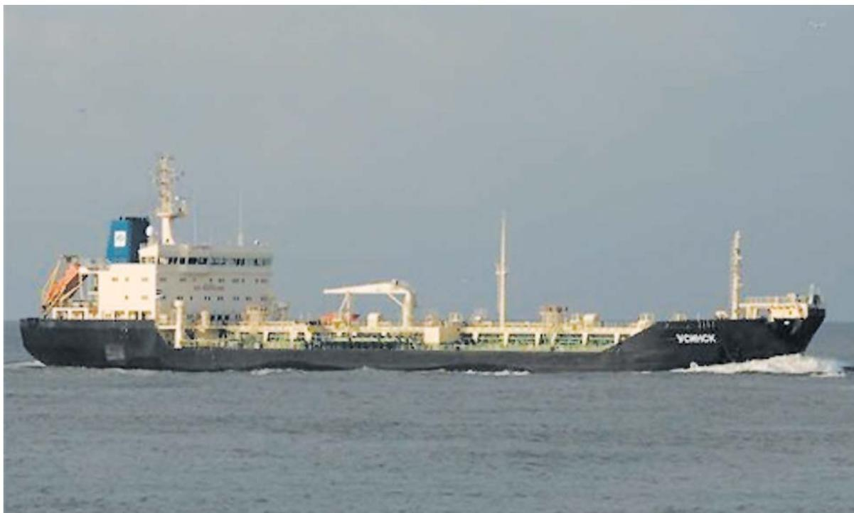
Рис. 16. Танкер усиленного ледового класса «Усинск»
