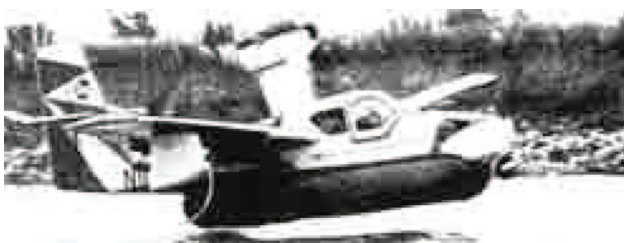
Рис. 16 Испытания СШВП Белл LA-4
