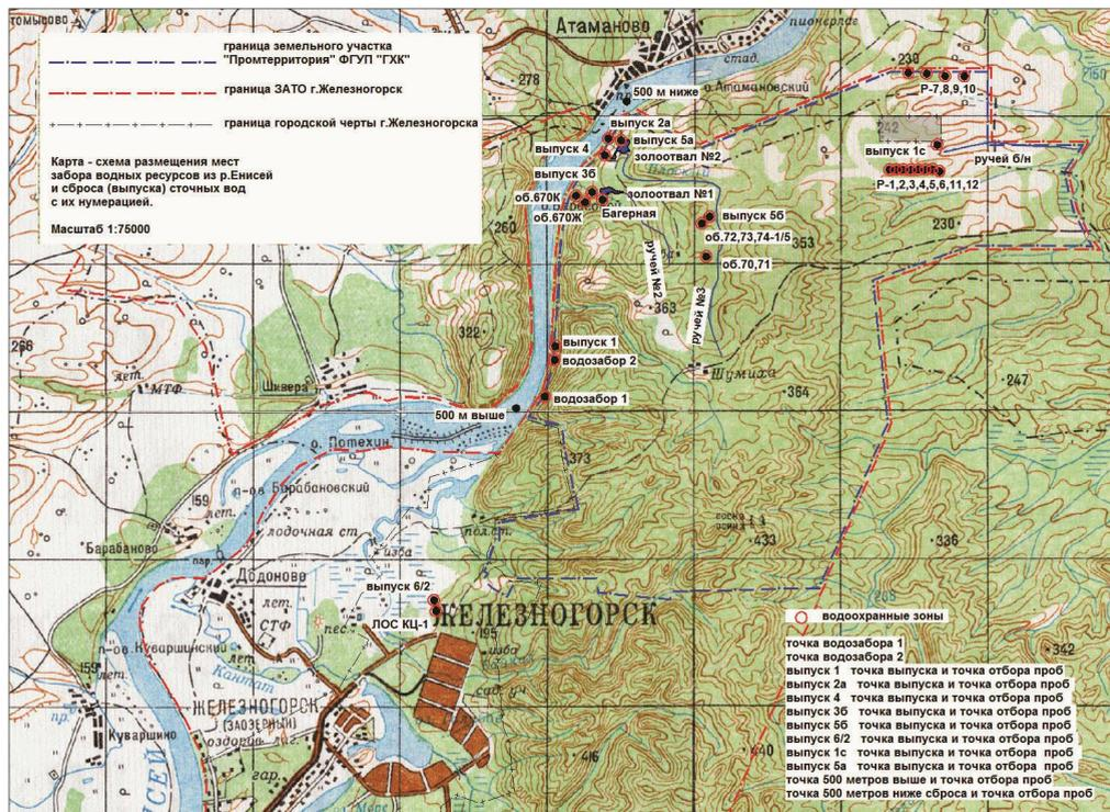
Рисунок 3.107 - Схема размещения мест забора водных ресурсов из р. Енисей и сброса сточных вод с их нумерацией
