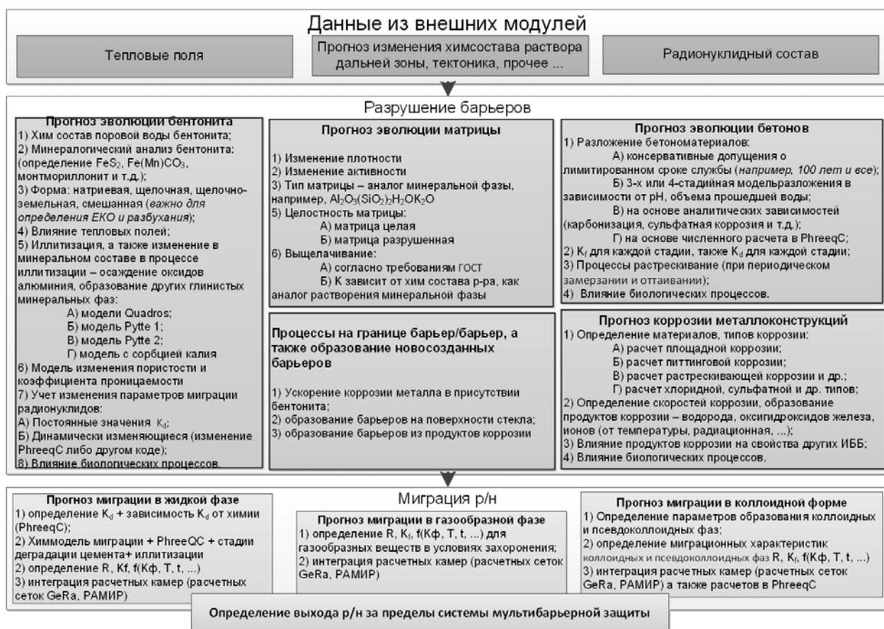
Рисунок 5 – Функциональная структура РПК Б
