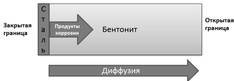
Рисунок 24 – Схема диффузионной задачи.
